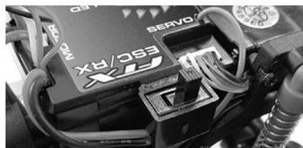
Allumez votre récepteur grâce à l'interrupteur du récepteur/ contrôleur de vitesse situé sous la carrosserie. Comme montré sur la photo.
