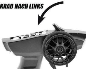
2. Um das RC-Modell nach links zu lenken, muss das Lenkrad nach links gedreht werden. Dabei ist der Lenkausschlag der Räder direkt proportional zu Einschlag des Lenkrades.
